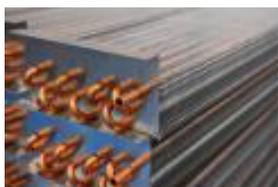
Serpentín Evaporador Cobre - Aluminio ofrece flujo contracorriente, todos con aletas de aluminio unidas a un tubo de cobre estriado interiormente para mayor eficiencia. Con una bandeja de drenaje a prueba de corrosión hecha de polímero para mayor durabilidad.
